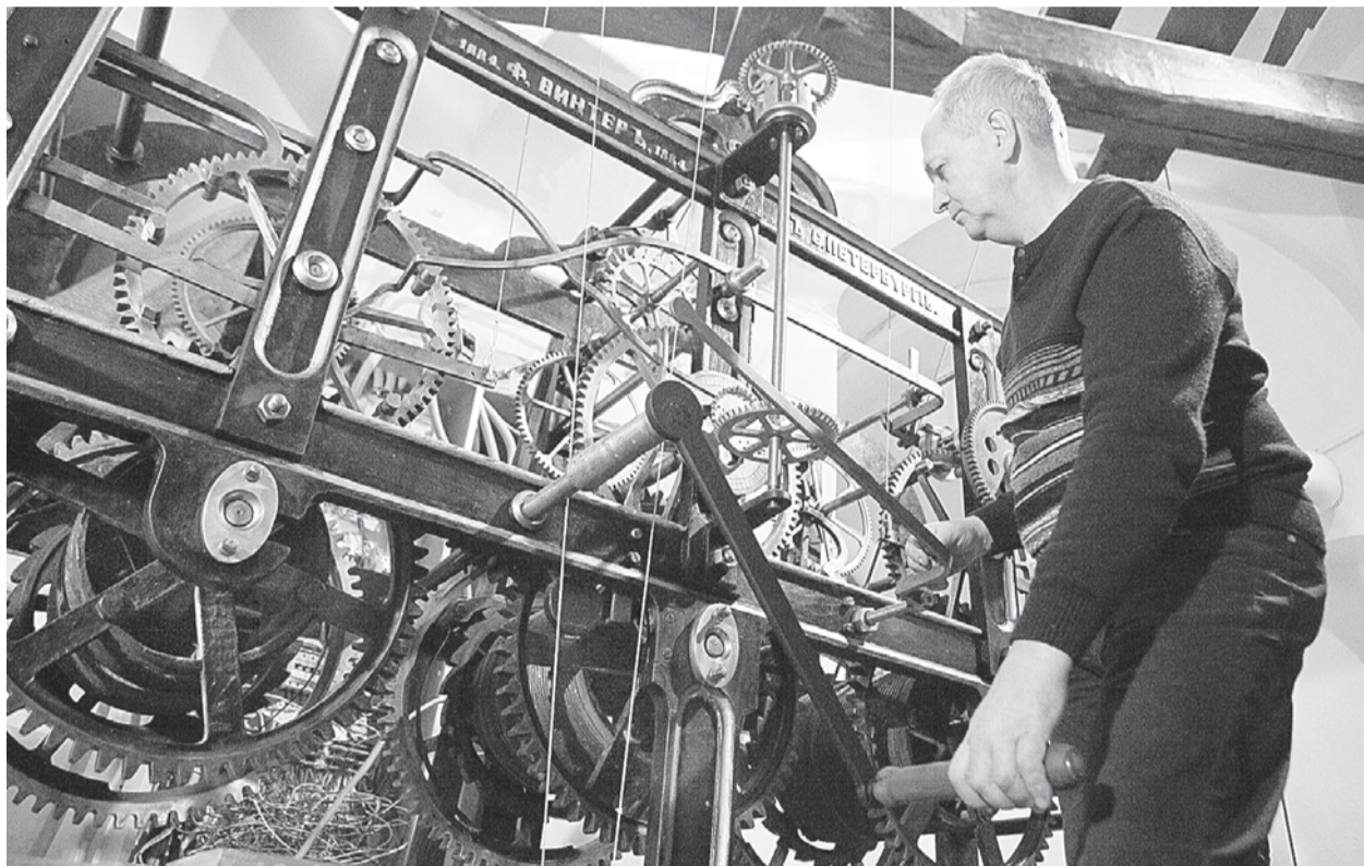
Для заводки часов требуется сделать 760 оборотов, что и продемонстрировал журналистам часовщик Андрей Кудрявцев.
