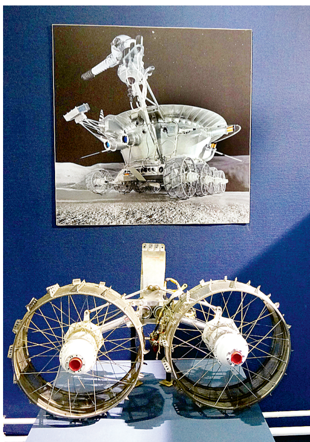
Макет колес лунохода в натуральную величину.
