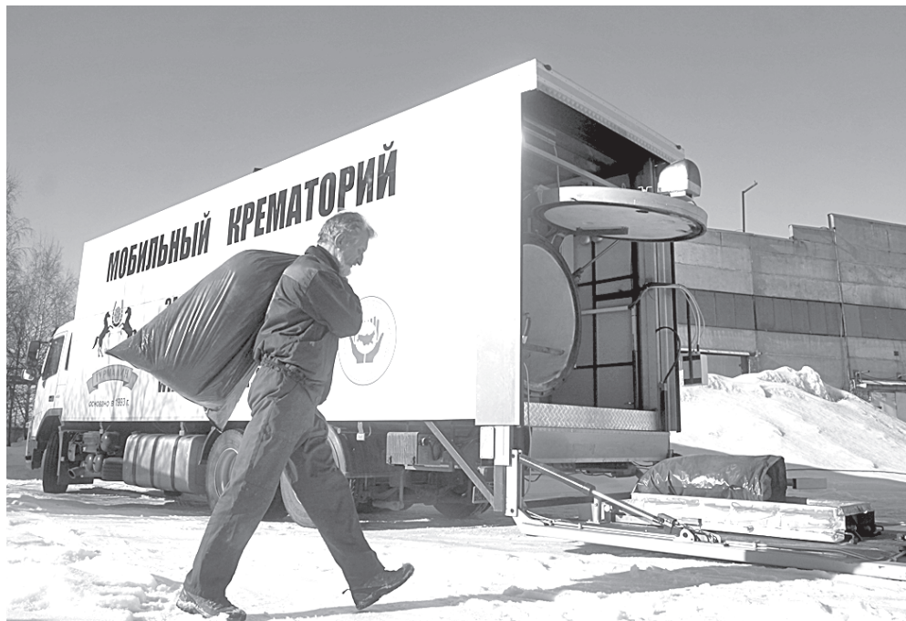
Такой аппарат способен сжигать 50 кг биомассы в час.
